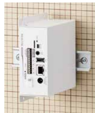
『DRA-2』(株式会社タカチ電機工業製)を使用することで、DINレールへの取り付けが可能。 ※DRA-2はお客様に別途ご用意ください。
